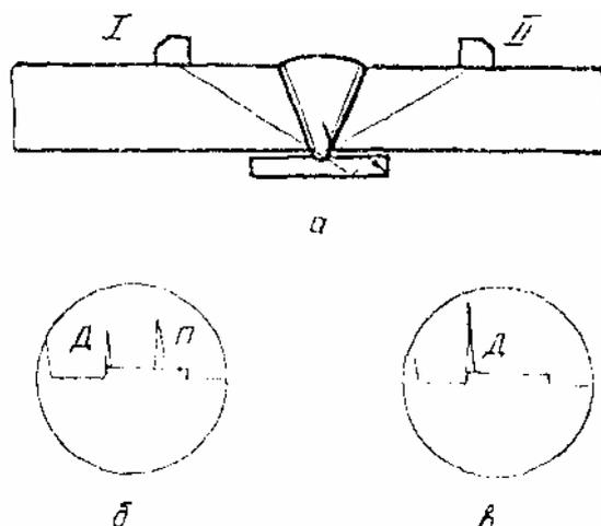
Рис 26. Схема обнаружения трещины в корне шва:
