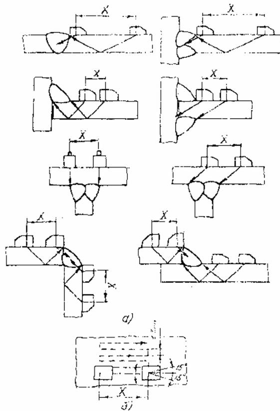
Рис.9 Сканирование при контроле сварных швов:
