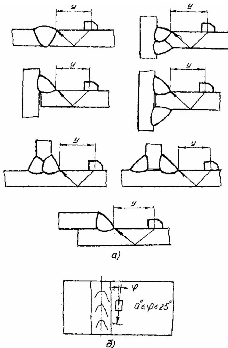
Рис.11. Сканирование при контроле околошовных зон:
