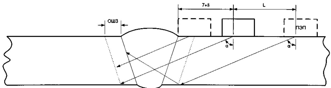
Рис. 2 Схема сканирования СС (показано прозвучивание с одной стороны); ОШЗ равна толщине СС,  $L+(7\div8)$  мм – зона сканирования;  $L=H\tan\alpha$
