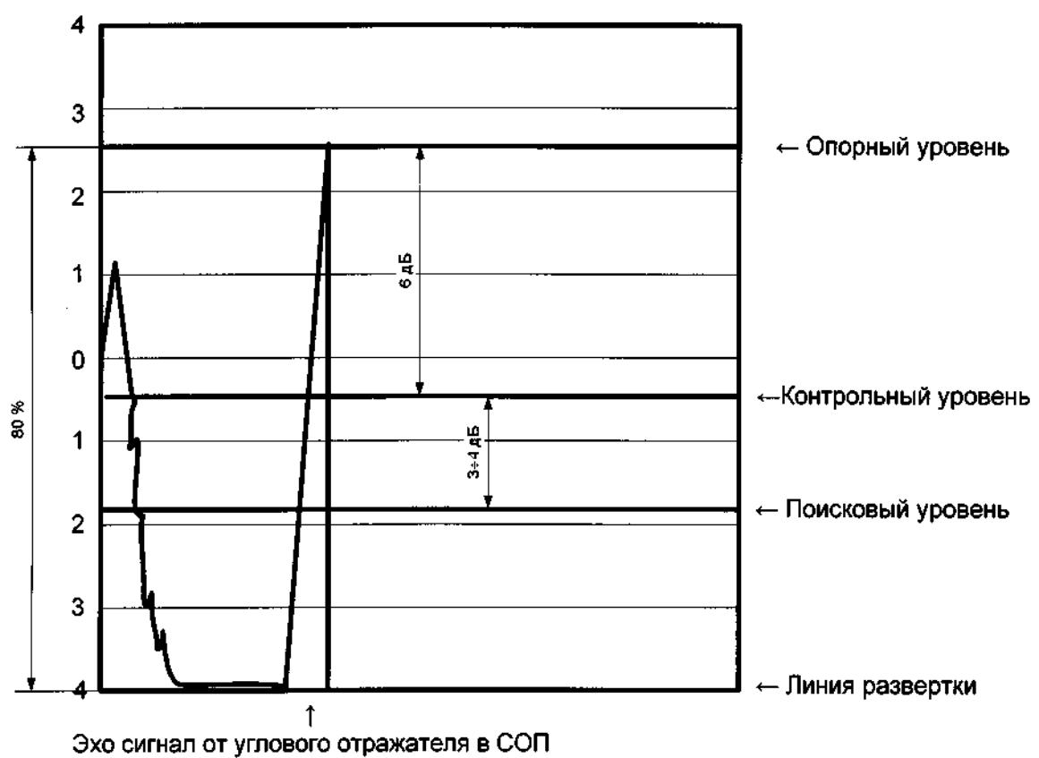
Рис. 1 Осциллографма экрана дефектоскопа и уровни чувствительности контроля
