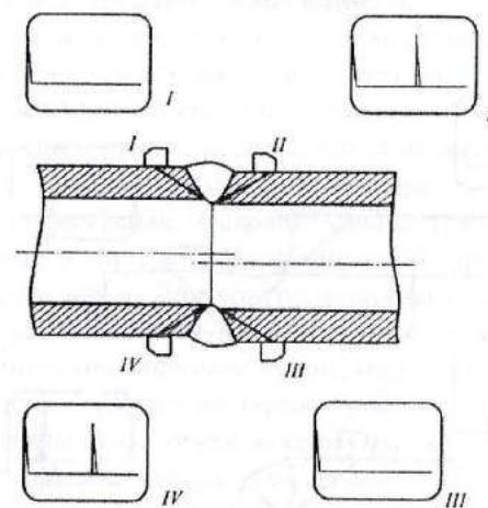
Рис. 3.13. Определение смещения кромок:
