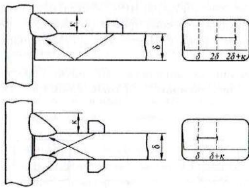
**Рис. 18.** Схемы контроля тавровых сварных соединений, выполненных без разделки кромок:  $H$  — зоны эхо-сигналов от дефектов
