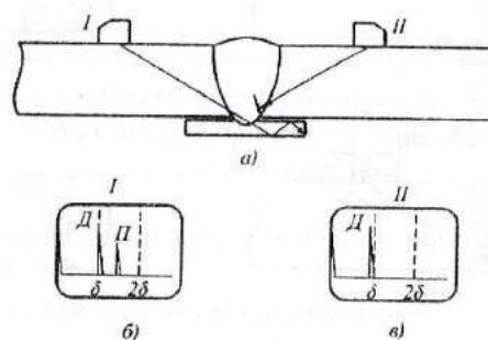
Рис. 3.8. Схема обнаружения трещины в корне шва:
