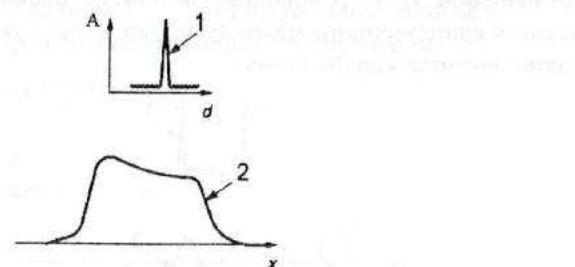
а) А-скан и изменение амплитуды эхо-сигнала при перемещении ПЭП
