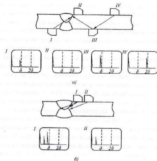
**Рис. 3.6.** Выявление непроваров (несплавлений) по кромкам
