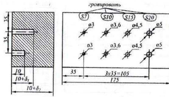
Рис. 3. НО для настройки дефектоскопа при контроле сварных швов прямыми РС ПЭП:  $\delta_1$  — толщина элемента, со стороны которого проводится прозвучивание сварного шва;  $\delta_2$  — сумма толщины элемента и ширины контролируемого шва
