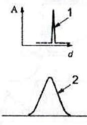
а) А-скан и изменение амплитуды эхо-сигнала при перемещении ПЭП
