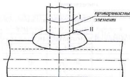
Рис. 22. Угловое соединение труб: I — граница защищенной зоны (параллельно границе усиления); II — граница шва
