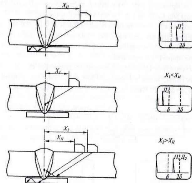
**Рис. 3.7.** Схема обнаружения подкладной пластины
