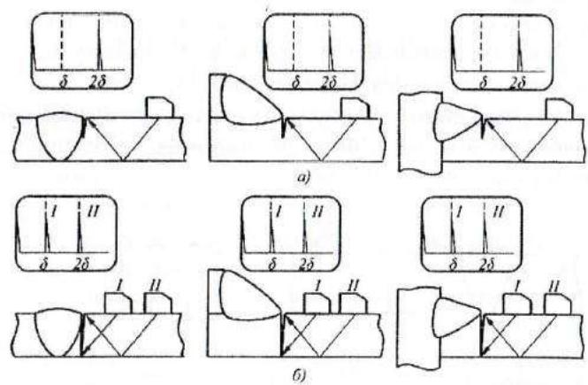
**Рис. 3.3.** Выявление трещин в местах перехода от наплавленного металла к основному:  $\delta$  – положение эхо-сигнала при озвучивании зарубки прямым лучом,  $2\delta$  – положение эхо-сигнала при озвучивании зарубки однократно отраженным лучом
