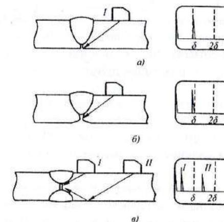
Рис. 3.5. Выявление непроваров в корне швов односторонних (а, б) и двусторонних (в) стыковых соединений  $\delta$  – положение эхо-сигнала при озвучивании зарубки прямым лучом,  $2\delta$  – положение эхо-сигнала при озвучивании зарубки однократно отраженным лучом
