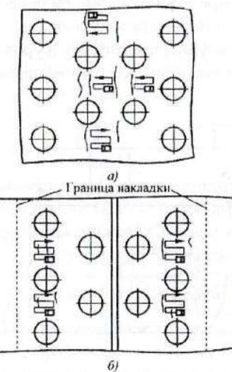
**Рис. 12. Сканирование при выявлении трещин по «мостикам» между отверстиями в заклепочных и (или) болтовых соединениях (заклепки и болты условно не показаны):**
