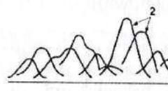
а) А-скан и изменение амплитуды эхо-сигнала при перемещении ПЭП
