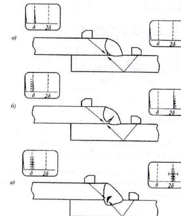
Рис. 3.12. Выявление дефектов в корне швов нахлесточных соединений
