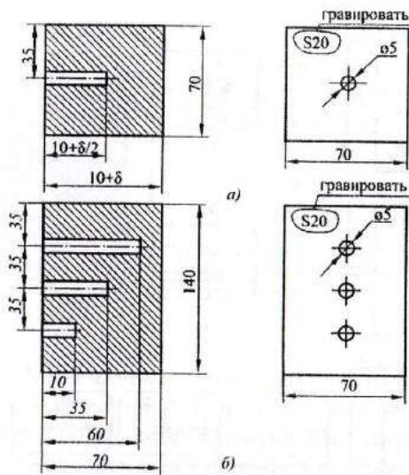
**Рис. 5.** НО для настройки дефектоскопа при контроле прямыми совмещенными и раздельно-совмещенными ПЭП при контроле околошововых зон и основного металла при номинальной толщине менее 20 мм (а) и при номинальной толщине от 20 до 60 мм включительно (б): δ — толщина контролируемого элемента
