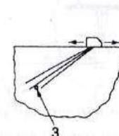
б) типичный случай при прохождении ультразвукового луча по толщине
