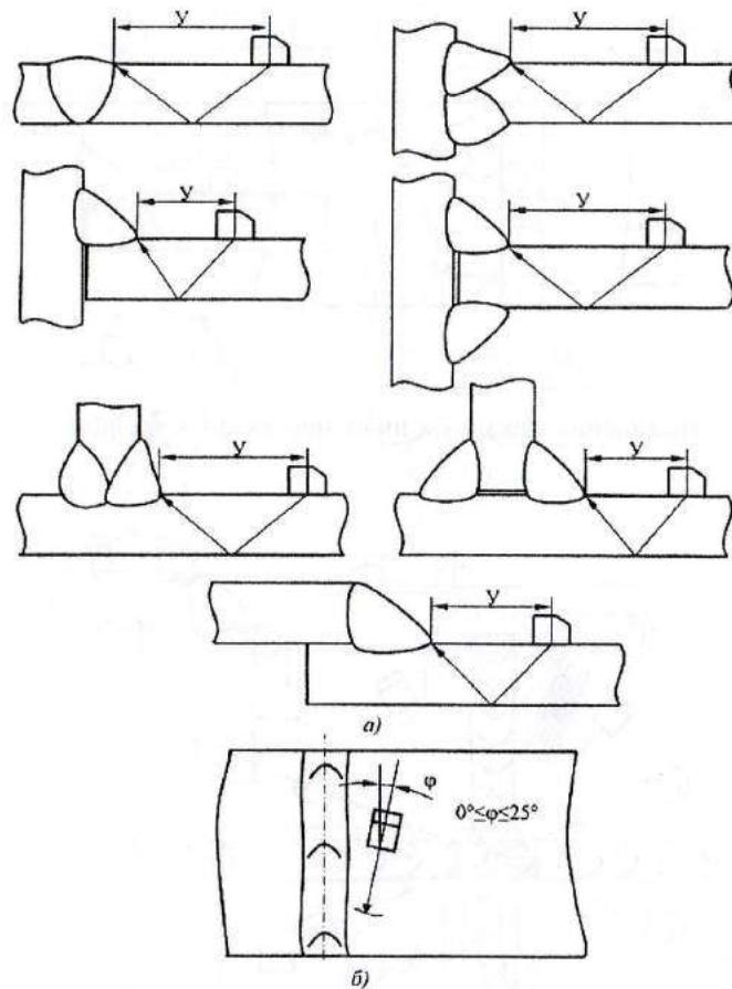
Рис. 9. Сканирование при контроле околошововых зон: а — прозвучивание мест перехода от наплавленного металла к основному; б — выявление поперечных трещин
