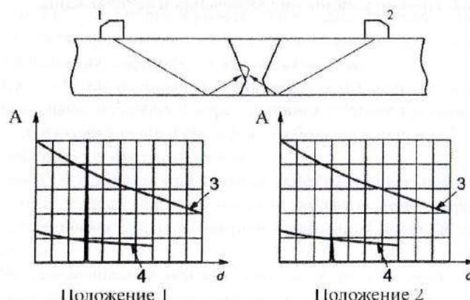
Рис. 4.4. Пример применения критерия направленной отражательной способности
