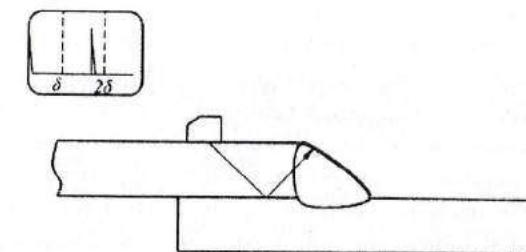
Рис. 3.11. Эхо-сигнал от поверхности шва нахлесточного соединения
