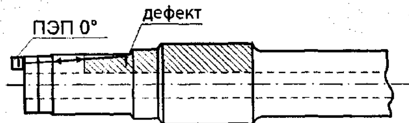
Рисунок 5.1 - Схемы прозвучивания и зоны контроля сплошных осей колесных пар при вариантах метода AR1.1 (а), AR1.2 и AR1.4 (б), AR1.3 (в)
