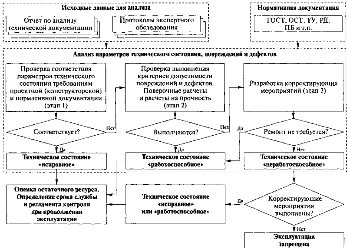
Рисунок 8.1 – Процедура оценки технического состояния сосуда
