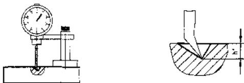
Рисунок Е.2 - Схема измерения глубины фрезерования сегмента
