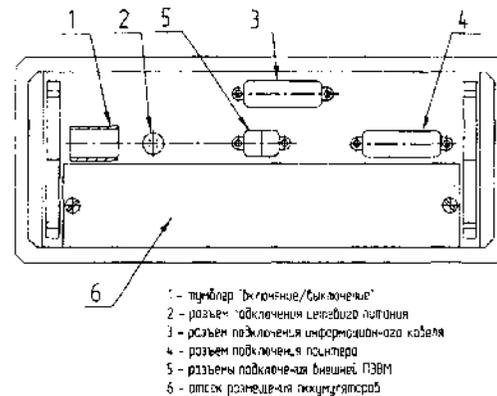
Рисунок Ж.2 - Задняя панель дефектоскопа
