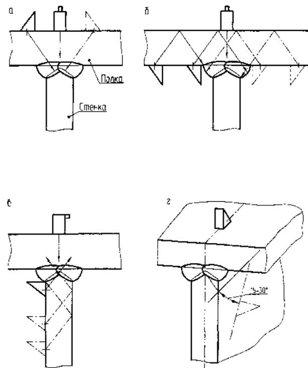
Рисунок 17 - Схема контроля тавровых сварных соединений
