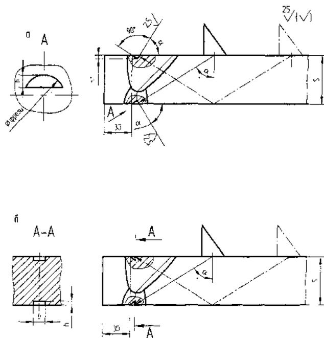
а - образец с сегментными отражателем;
