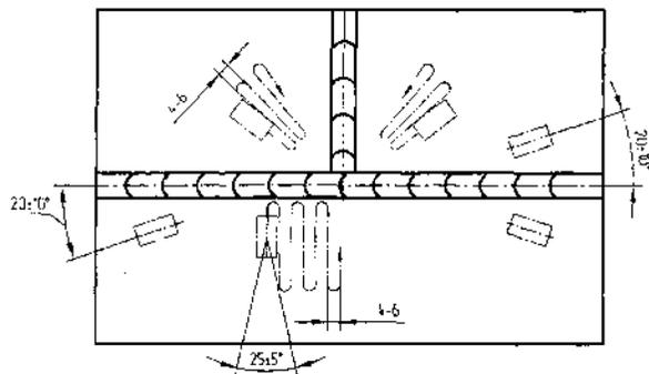
Рисунок 14 - Схема контроля места сопряжения сварных швов
