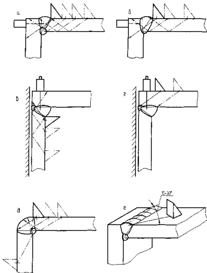
Рисунок 16 - Схема контроля угловых сварных соединений
