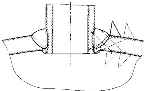
Рисунок 19 - Схема контроля сварных соединений
