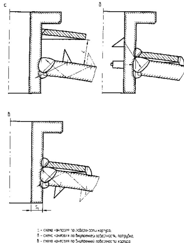
Рисунок 22 - Схема контроля сварных соединений с укрепляющим кольцом
