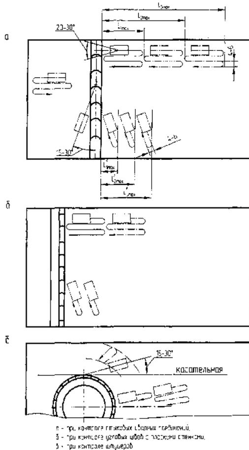
Рисунок 11 - Схемы перемещения преобразователей при контроле
