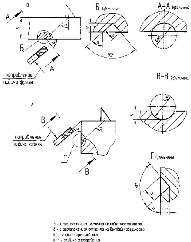
Рисунок Б.1 - Варианты исполнения сегментных отражателей
