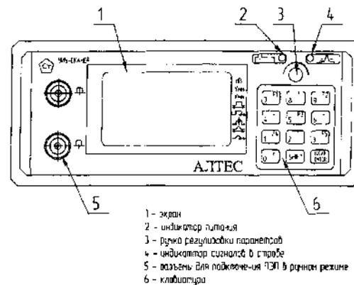
Рисунок Ж.1 - Передняя панель дефектоскопа
