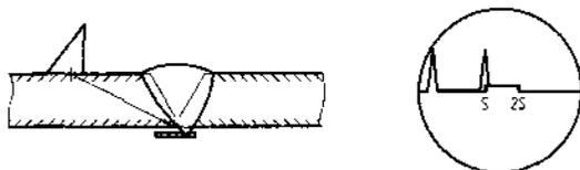
Рисунок 13 - Схема выявления эхо-сигнала от непровара и осциллограмма
