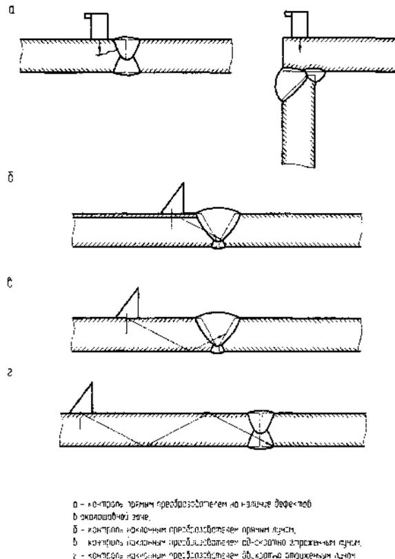
Рисунок 7 - Способы контроля сварных соединений
