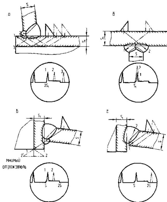
а - от угла трубы (луч 1) и от поверхности шва (луч 2),
