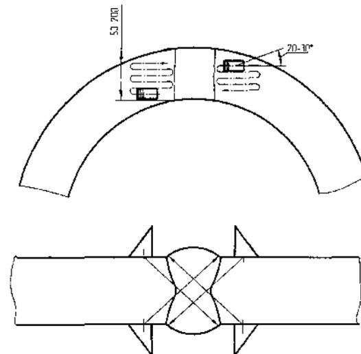
Рисунок 25 - Контроль сварных соединений фланцев
