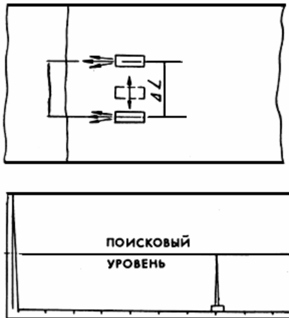
Рис.П14.7. Схема измерения условной протяженности дефекта
