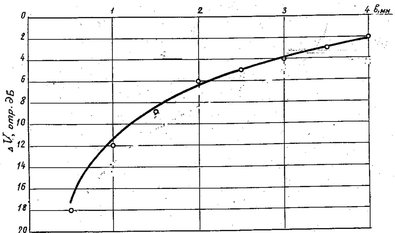
—, ● — расчет и эксперимент соответственно для наклонных преобразователей при  $\delta_0 = 25$  мм,  $\alpha = 6$  мм,  $\beta = 50^\circ$  ( $\chi = 65^\circ$ ),  $f = 2,5$  МГц,  $AZ = 6,5$  мм
