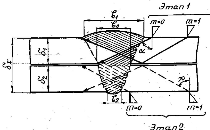
Контроль соединения выполняют в два этапа:
