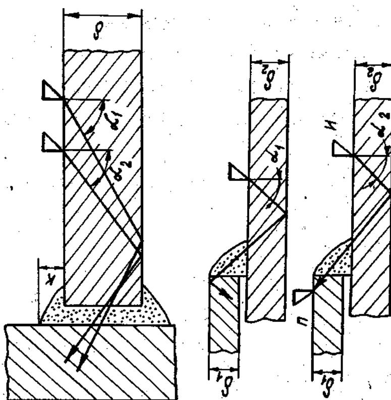
Для выявления дефектов, расположенных у торцов в стыковых, тавровых и нахлесточных соединениях, следует дополнительно прозвучивать зону у каждого торца, постепенно поворачивая преобразователь в пределах до  $45^{\circ}$  между торцом соединения и плоскостью падения волны.
