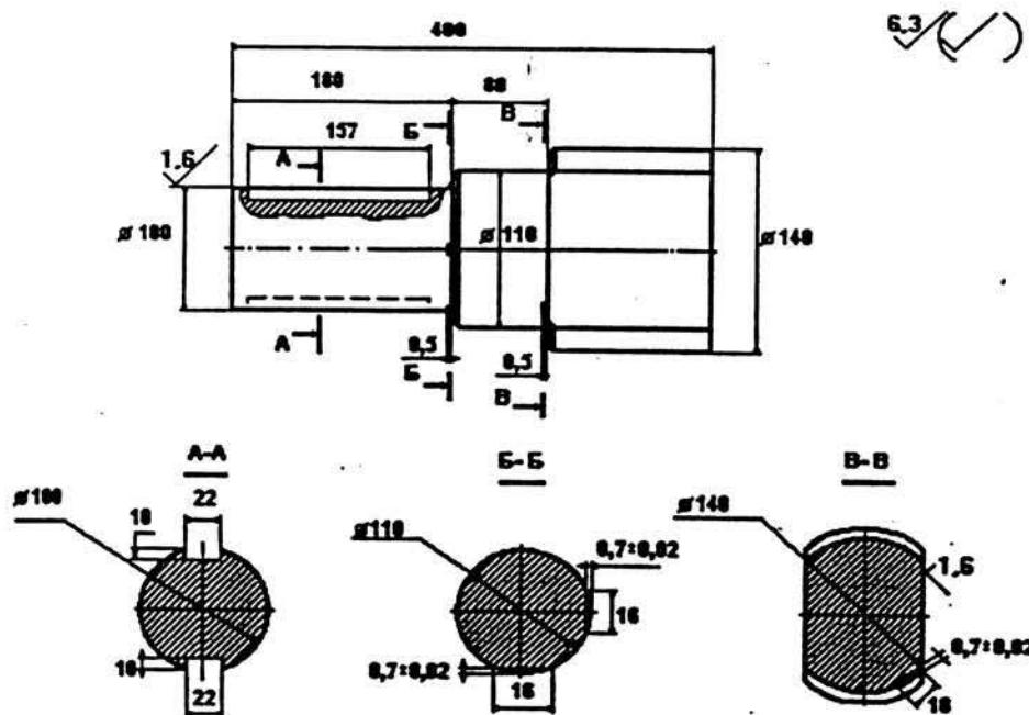
Испытательный образец для настройки на контроль цапф (эскиз).
