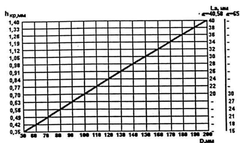
Рис.4. Зависимость браковочных критериев от диаметра малой ступени цапфы.
